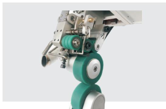
**2** I due rulli trasportatori sono indipendenti e controllati da due motorini passo-passo, ideale per impostare un trasporto differenziale sopra/sotto.
